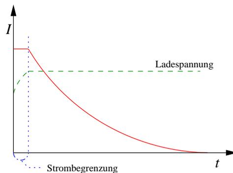
möglichkeiten für Spannung und Strombegrenzung. Es dürfen nur Akkumulatoren mit der entsprechenden Spannung angeschlossen werden. Das Laden eines 6V-Bleiakkumulator an einem 12V-Gerät oder umgekehrt ist zu unterlassen. Ferner darf die Strombegrenzung des Gerätes, die des Akkus nicht überschreiten. Dies kann u.U. bei Anschluss einer kleinen Moped-Batterie an ein Gerät für Auto-Batterien
