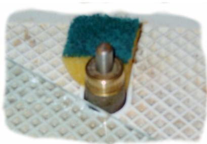
Links: Stumpfschleifen mit einer Glasschleifmaschine
