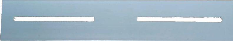
Dann wird eine Nut eingefräst, in der dann mittels Schrauben die quadratischen Halter befestigt werden. Die Nuten sollten einen Abstand zum Rand von ca. 1 cm und untereinander einen Abstand von ca. 4 cm haben, somit hat der Deckelteil noch genügend Stabilität um nicht auseinander zu brechen und die Gesamte Aufhängung am Küvettenrand zu halten.
