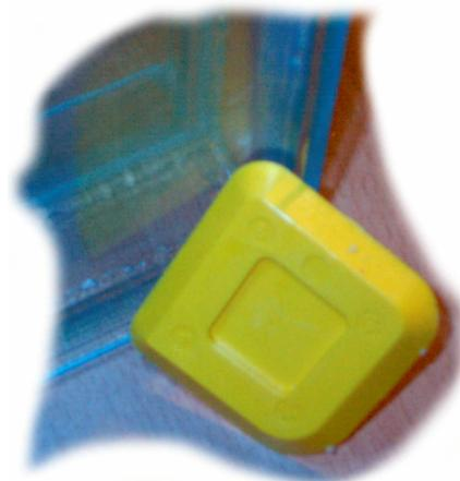
**Die Fugenhilfe immer vor dem abziehen von Silikon befreien (mit Küchenkrepp abwischen) „sonst verschmiert's alles“**
