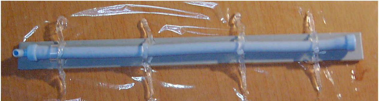
Da das Silikon in die Senkungen gepresst wird hält dies mechanisch, sozusagen wie ein Niet oder
